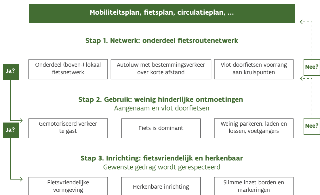
Fig. 1: Afwegingskader voor de toepassing van fietsstraten
